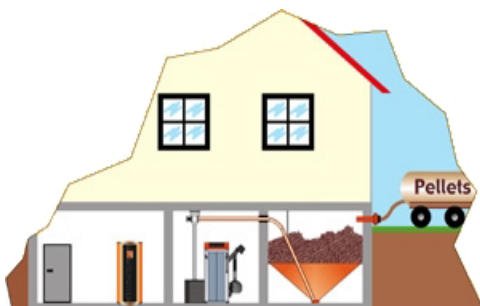
Pellets-Heizung mit Silo
